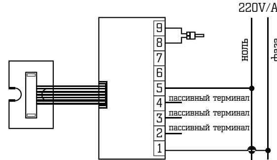
БВ системы электроотопления/контроль с помощью двух датчиков
