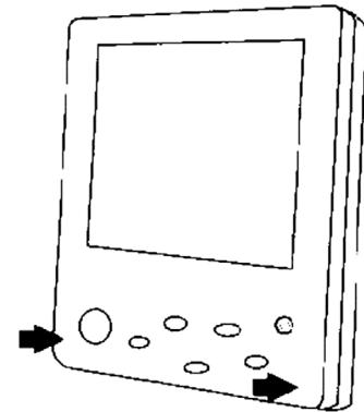
**Шаг 8.** Слегка прижмите нижние углы, закрепите корпус и завершите монтаж.
