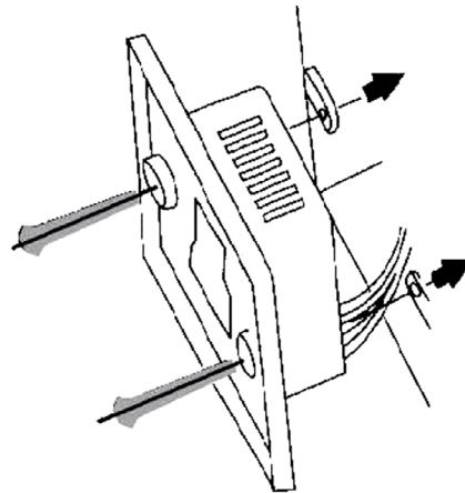
**Шаг 5.** Закрепите щит двумя шурупами, которые прилагаются в комплекте.
