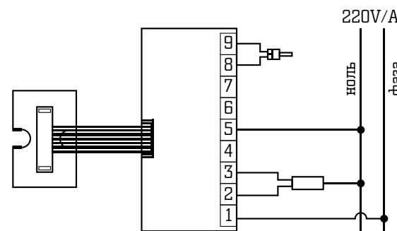
БА для нагрева воды/контроль с помощью двух датчиков/Пассивная часть
