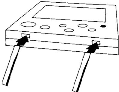
**Шаг 1.** Откройте контрольный щит: используйте отвертку на 3,5 мм. Вставьте отвертку в пазы на 4 мм.
